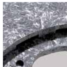
Kohlenstofffaserverstärkte CMC-Werkstoffe, z. B. für den Einsatz in tribologischen Anwendungsgebieten
