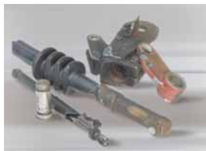
Abhängig von Einsatzdauer und Beanspruchung: ausgeschlagene Lager, Verbindungen und stromführende Teile
