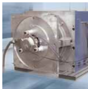
Testanlage für Erdungskontakte. Messung der Wärmeentwicklung der Kohlebürsten
