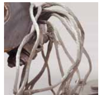
Gerissene Strombänder eines Stromabnehmers
