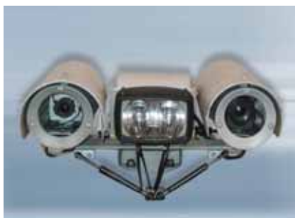
Mit der auf dem Meßzug installierten Kamera wird das Laufverhalten des Stromabnehmers während der Fahrt beobachtet. Stör- und Fehlstellen werden frühzeitig erkannt
