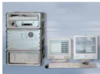
Direktübertragung während der Fahrt. Auf den Bildschirmen im Meßzug erscheinen die "Livebilder": Lage und Verhalten des Fahrdrabtes, Anpreßkraft etc.
