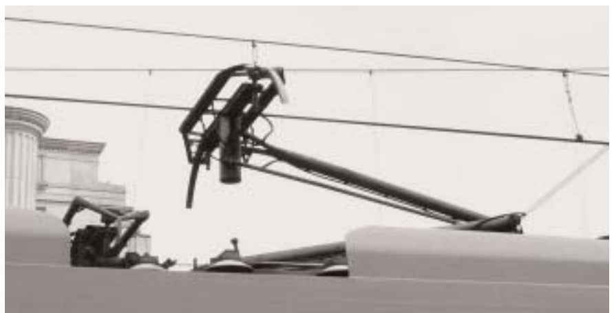
Separate Dachstromabnehmer am TGV für AC-Betrieb (links) und DC-Betrieb (rechts)
